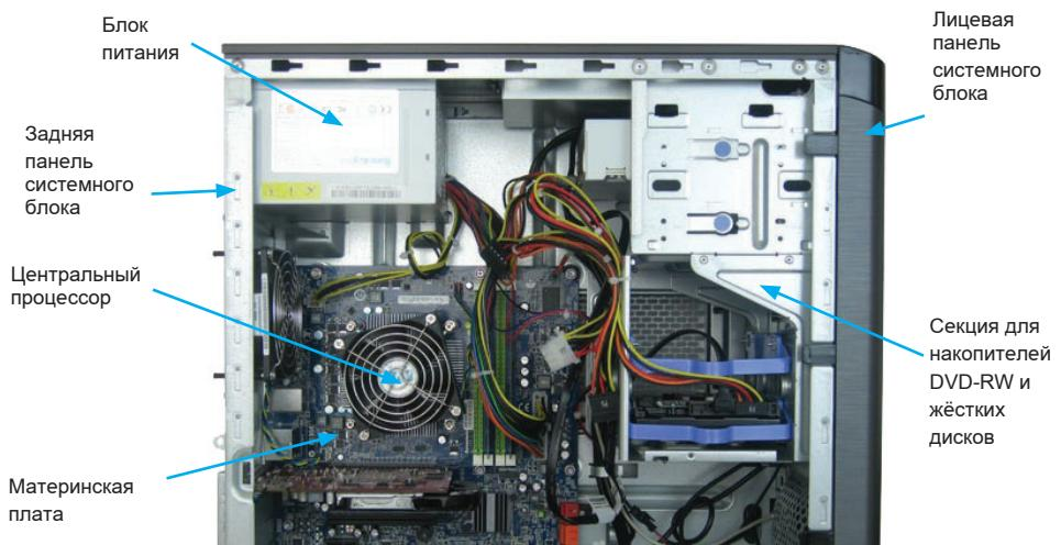
*Рис. 3. Устройства системного блока*
